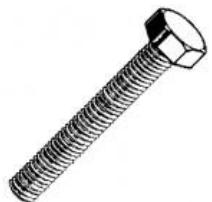
Označení šroubů a vrutů ..... M 5 x 30 .... 5 = průměr dříku v mm, 30 = délka dříku v mm
